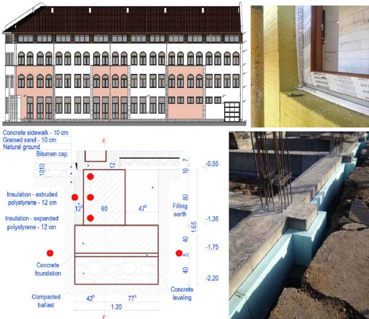
Fig. 1. Fațadă școlii, izolarea termică a pereților și a fundațiilor [2]
