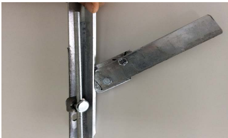
Foto nr.13 Electrode de împământare cu elemente de conexiune înainte de a fi expus în " Camera climatică "
