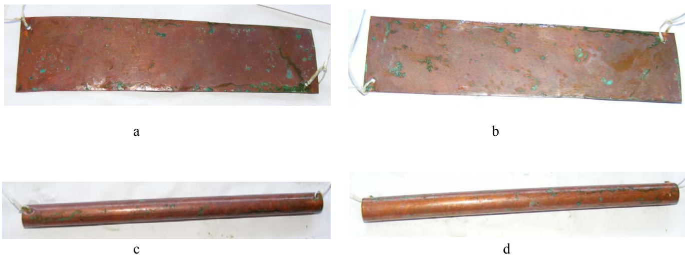
Foto nr. 7 a și b – placa de Cu corodată; c și d – bara de Cu corodată. Data: 13.07.2018
