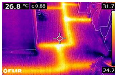
Fig.6 Identificare traseu încălzire prin pardoseala
