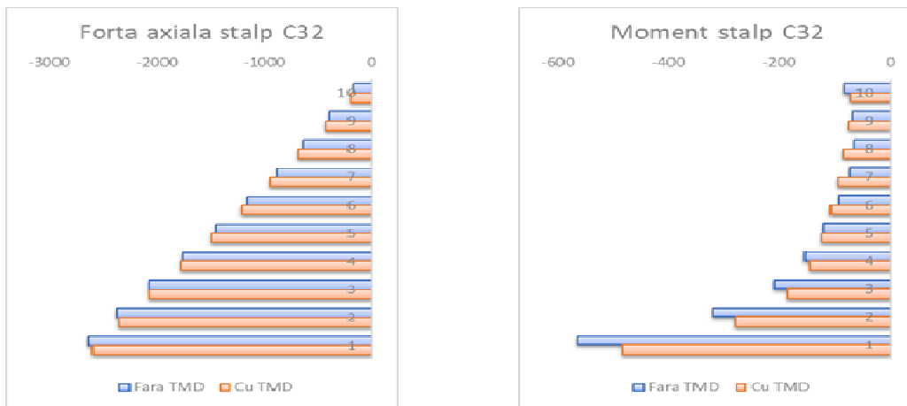
Fig. 53 Forta axiala si momentul incovoietor in stalpul de colt C32
