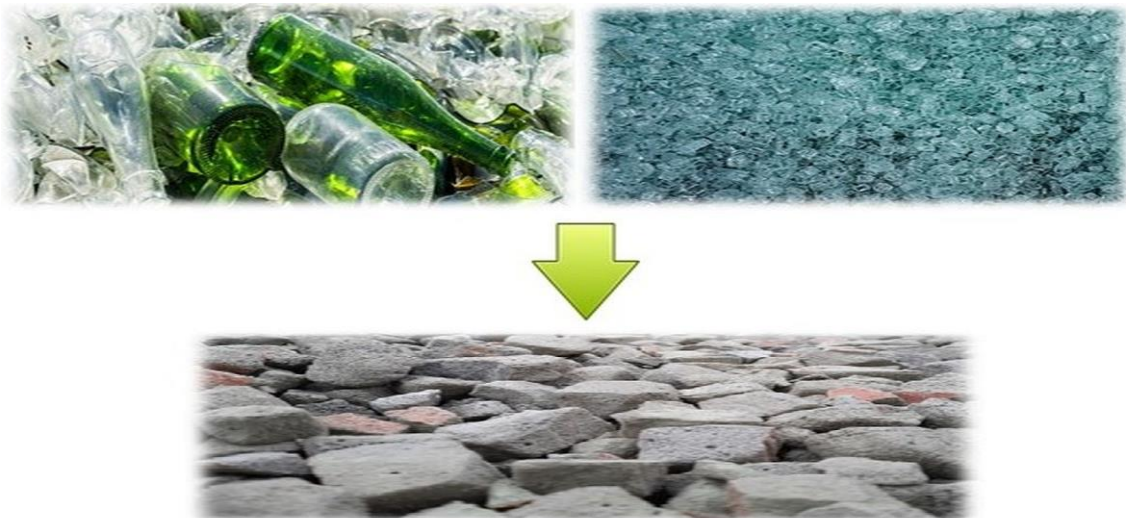
Fig. 2 Procesul de fabricare al sticlei celulare [5] [6]
