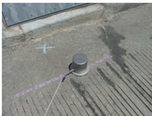
Figura 7 Accelerometru pe suprafața podului
