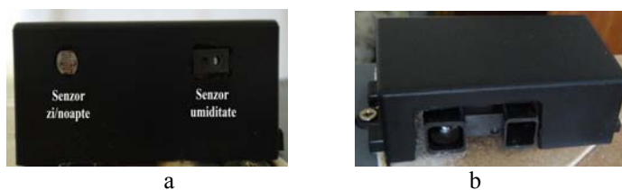
Fig. 3 Senzorii platformei experimentale a) senzorii zi/noapte și umiditate; b) senzorul distanță.
