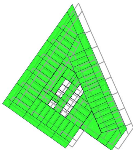
Fig. 1. Forma proprie de vibrație asociată modului 1- translație pe direcția X (T=3,33sec)
