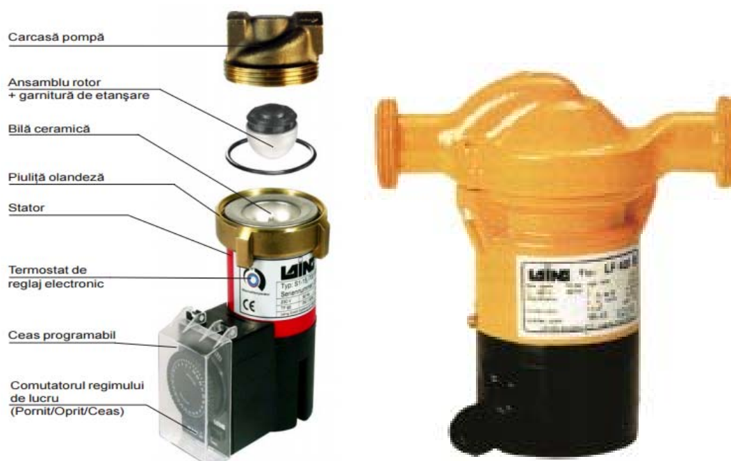
Figura 6. Pompa Laing – piese componente
