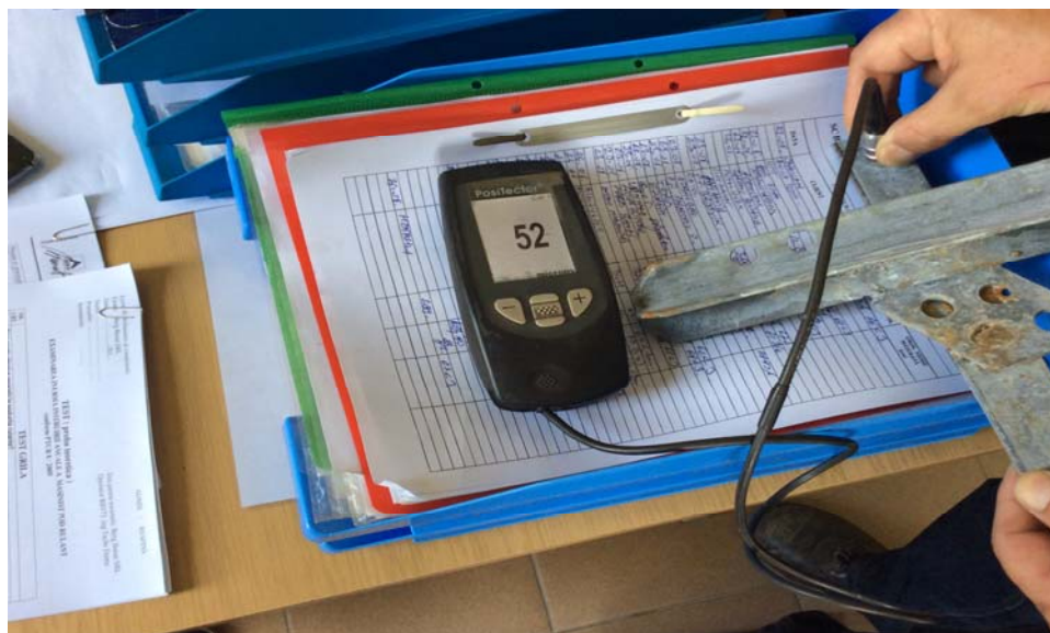
Foto nr. 18 Aparat de măsură pentru grosimea stratului de acoperire (zinc) "PosiTector" [13]
