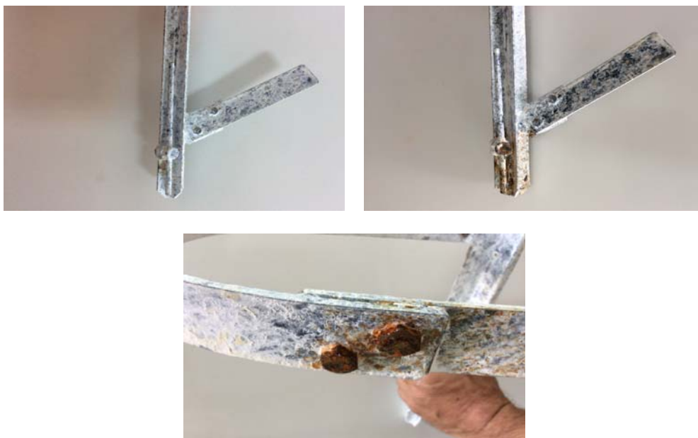
Foto nr. 14 Electrode de pământare cu elemente de conexiune după expunerea în " Camera climatică ", coroziune și ZnO (oxid de zinc)
