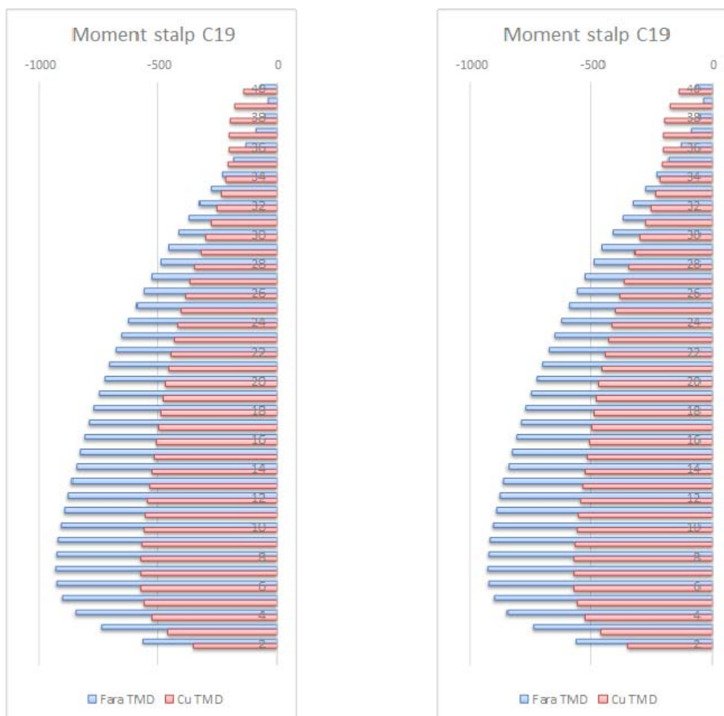
Fig. 30 Forta axiala si momentul incovoietor in stalpul marginal C19
