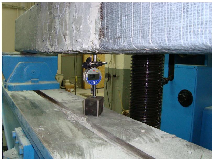
Foto 2 - Consolidarea grinzii cu benzi și țesături din fibre de carbon
