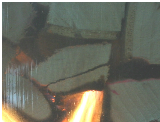
Fig.10 Masivul de lemn în strat în faza de ardere cu exces de căldură disipat în aval
