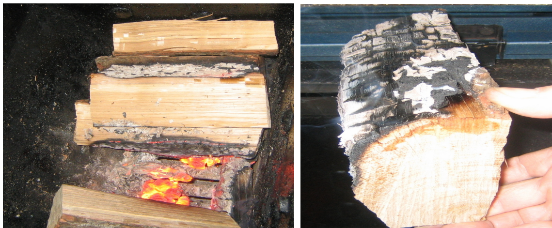
Fig.7 Desvoltarea la suprafața lemnului a stratului de cocs
