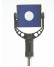
Fig. 3. Ținta de 3'' folosită la scanare
