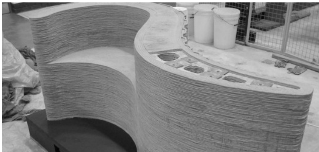
Fig. 15 – Element de construcție complex din beton armat printat 3D / arhitectură-structură-instalații (sursa : http://www.3d-printers.com.au/2010/11/17/concrete-3d-printer/ )
