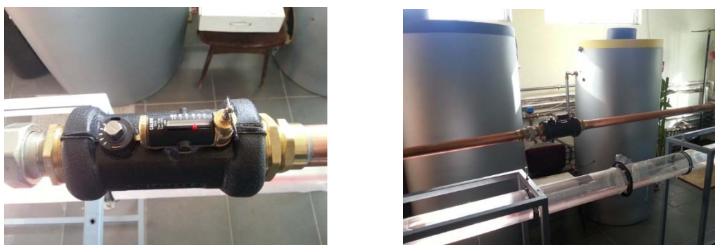
Figura 4— Poziția vanei de reglaj cu fluxometru CALEFFI în cadrul modelului experimental
