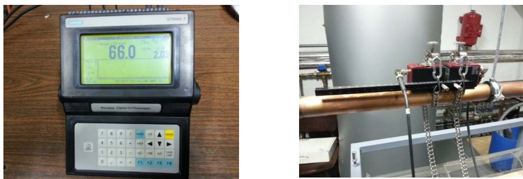
Figura 5— Debitmetru cu ultrasunete SIEMENS SITRANS F; Montaj debitmetru cu ultrasunete
