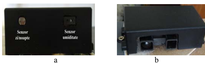
Fig. 3 Senzorii platformei experimentale a) senzorii zi/noapte și umiditate; b) senzorul distanță.
