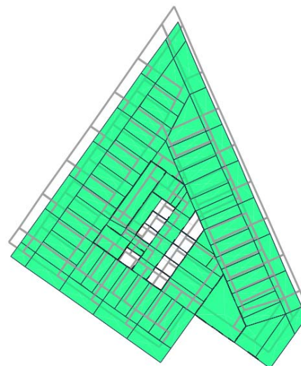
Fig. 2. Forma proprie de vibrație asociată modului 2- translație pe direcția Y (T=2,73sec)
