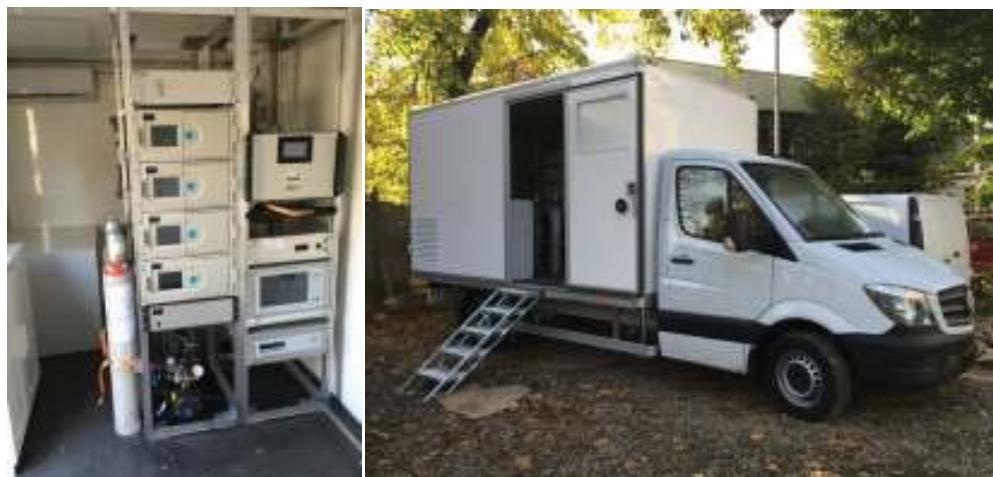
Figura 1 : Imagine cu autolaboratorul mobil pentru măsurarea imisiilor
